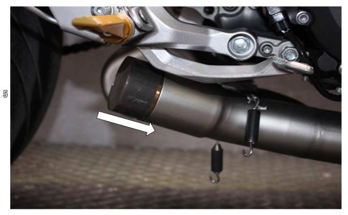
Montieren Sie den REMUS Schalldämpfer, hängen Sie die Federn ein un ziehen Sie die Halterschraube fest. (Abb.6) Mount the REMUS muffler, mount the springs and tighten on the bracketscrew. (pic.6)
