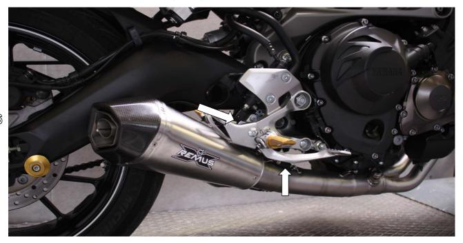
Nach 100 Kilometer Fahrstrecke die angeführten Schrauben kontrollieren, bzw. wenn erforderlich nachziehen !
